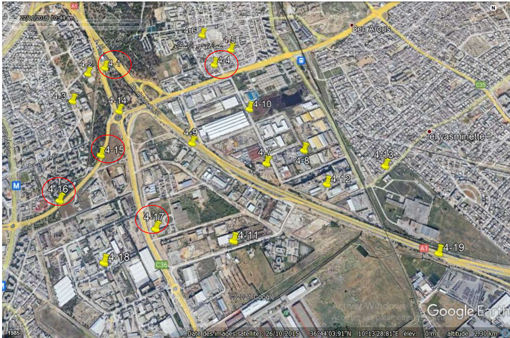
Plan de localisation des stations de mesures des paramètres environnementaux du lot 4 (en cercle rouge qui présentent des dépassements en PM10)
